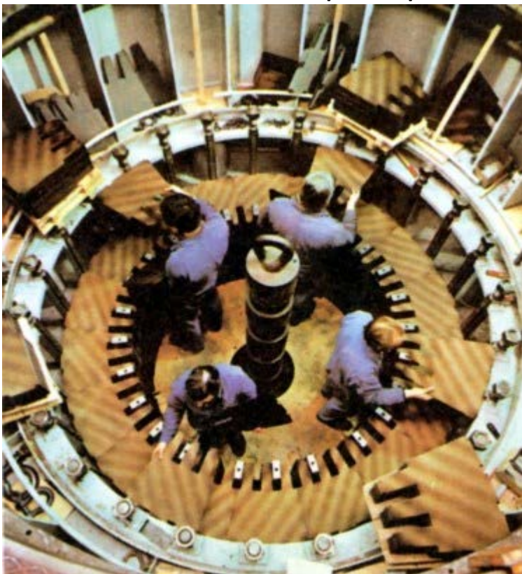
ci-dessus: empilage des tôles magnétiques dans un stator de petit diamètre, on remarque les encoches qui recevront les conducteurs de l'induit. document CEM
